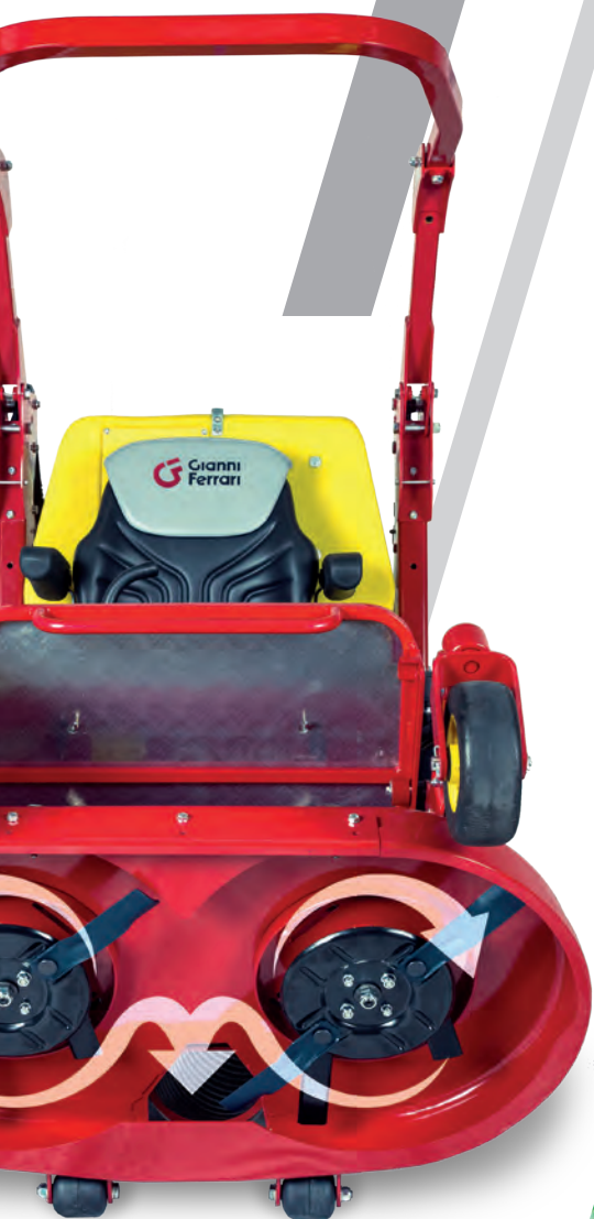
Umgekehrte Drehrichtung der Messer
